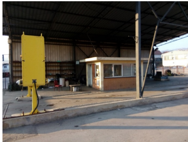
Слика 10. Колска вага PAR VAG носивости 60 тона
