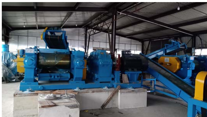
Слика 12. Дробилица са уздужним озубљењем
