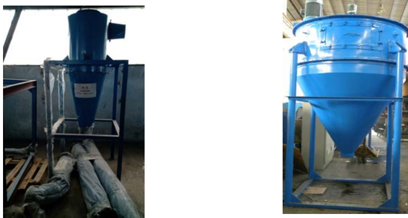
Слика 14. Сепаратори (циклони) за издвајање текстилних влакана
