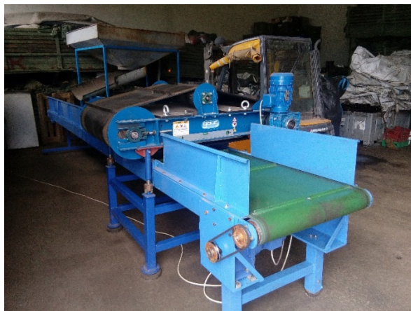
Слика 5. Магнетна трака за издвајање магнетичног отпада (пример)
