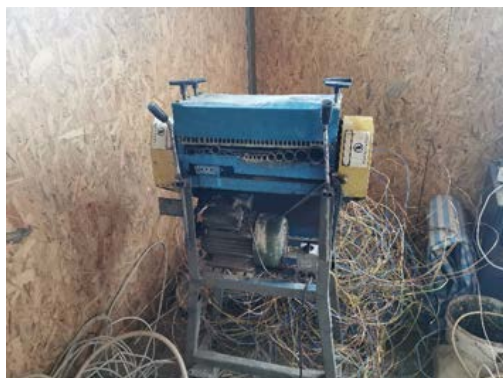
Слика 8. Машина за расклапање електричних каблова
