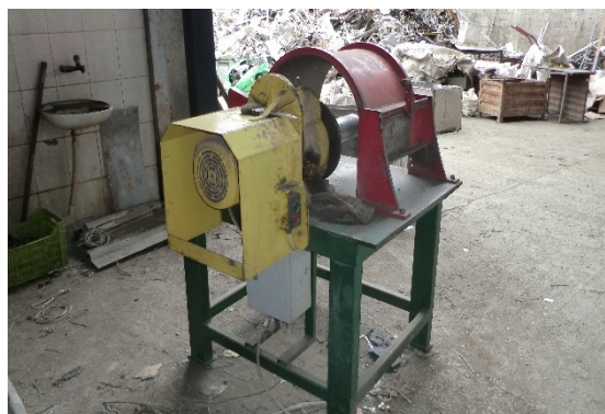
Фото 9. Машина за расклапање Al -Ћ жица
